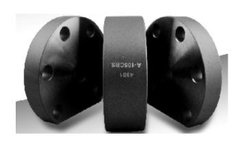
高压阀门配件系列 材料: A105 规格: 1/2"、3/4"、1"、1-1/2"、2" 技术要求和用途: 表面粗糙度Ra0.8;粗糙度Ra0.4 主要用于石油化工行业
